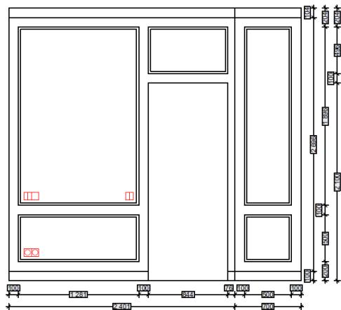
Далее делаем чертёж с отделкой. Указываем где какое покрытие на стенах, считаем квадратуру или рулоны, добавляем декоративные элементы, например, деревянные рейки. Также делаем развёртки в сложных местах, чтобы никто не запутался:)
