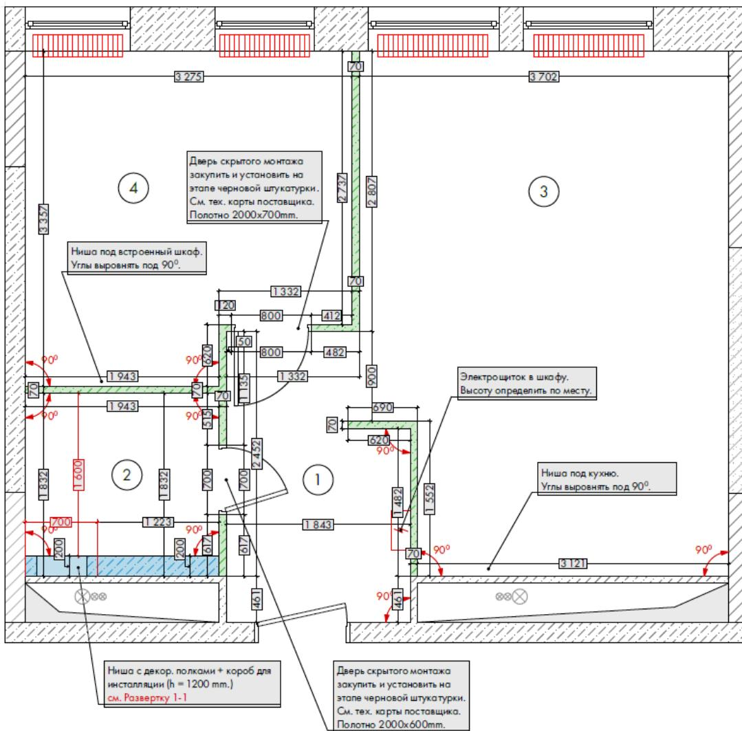
На монтажном плане указываем стены и конструкции, которые нужно возвести. Также не забываем про толщину шумо- и теплоизоляции, если она вам нужна. В сложных местах мы добавляем развёртки по стенам. А ещё указываем какие углы нужно выровнять для встроенной мебели и плитки. Это очень важно!
