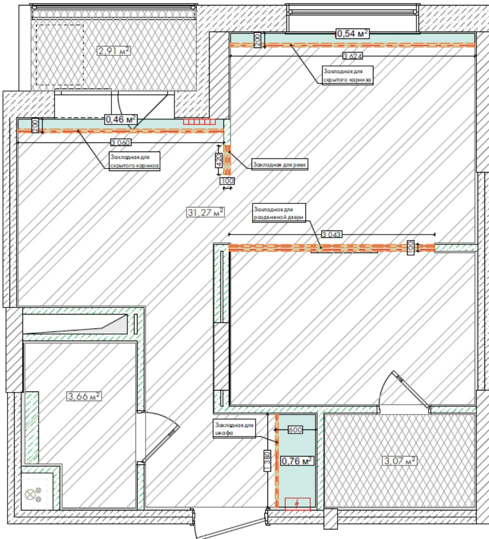
На плане с потолочными покрытиями указываем где и какой потолок планируется, его квадратуру, на сколько опустится и не забываем про специальные элементы. Например, закладные под встроенную мебель до потолка или скрытые карнизы для штор.
