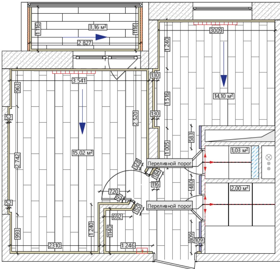
Переходим к техническому этапу. Он нужен, чтобы грамотно просчитать смету и сделать ремонт. Пожалуй, если сравнивать, то это мышцы проекта. Этот этап больше интересен для строителей, но без него никуда. Начинаем его с чертежа по напольным покрытиям. Указываем тип, пороги, толщины и направление.
